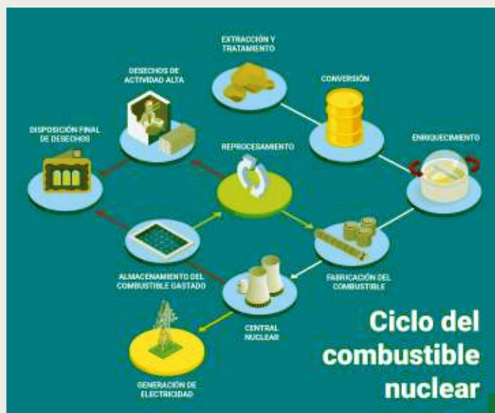
Una vez que la actividad disminuye lo suficiente, el combustible se traslada a un **almacenamiento en seco**, en silos de hormigón que contienen varios elementos combustibles, con un diseño que permite el enfriamiento por convección natural. Según la política de cada país, puede existir almacenamiento seco centralizado, donde se guardan todos los combustibles gastados, o sitios de almacenamiento temporal cercanos a cada central nuclear.
