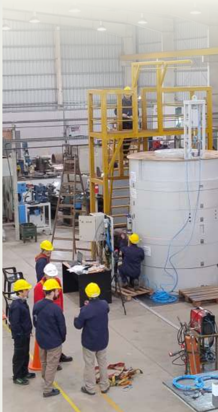
Prueba FAT: Blindaje de Monocromadores para ANDES
